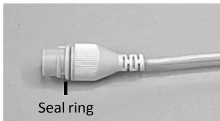
2. Stecken Sie die Wasserdichtigkeitskomponenten wie nachstehend gezeigt durch das Ethernet-Kabel.
